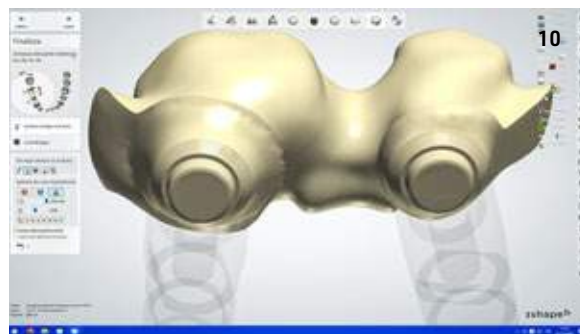
Fig. 10. Progettazione software del manufatto definitivo con connessioni dirette
