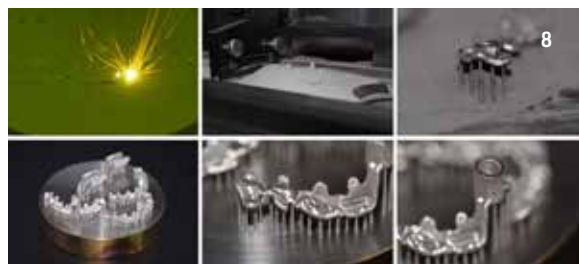
Fig. 8. Dettagli della produzione delle dime chirurgiche in laser sintering.
