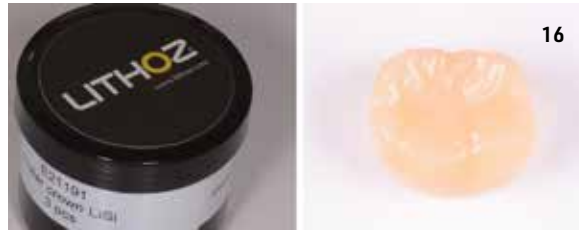
Fig. 16. Stampa 3D del restauro protesico attraverso tecnica Lithography-based Ceramic Manufacturing (LCM) con stampante CeraFab S65 Medical® (Lithoz, Vienna). Il restauro monolitico è stampato in disilicato di litio.
