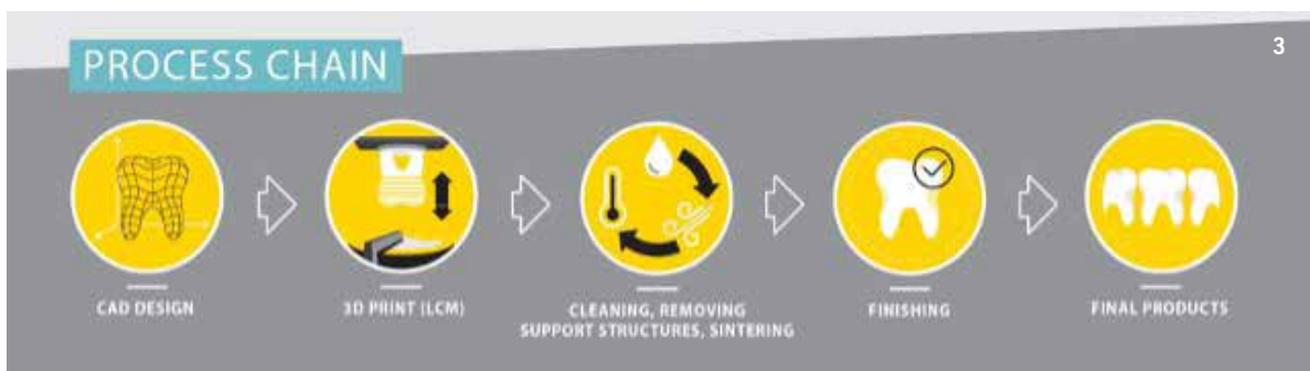
Figura 3. Catena di processo della tecnologia LCM di Lithoz, dalla progettazione al prodotto finale, rappresentata utilizzando un restauro dentale.
